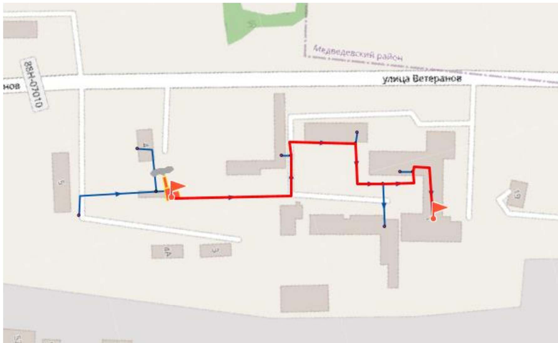
Рис. 6.11. Путь построения пьезометрического графика от котельной ООО "Марикомунэнерго ул. Ветеранов Шоя-Кузнецо до удалённого потребителя
